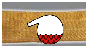
Повреждение в результате воздействия кислоты/щелочи
