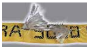
Повреждение внутренних прядей
