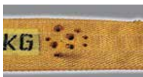
Повреждение в результате воздействия высокой температуры
