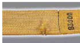
Повреждение основного шва
