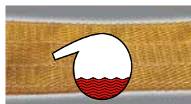
Повреждение в результате воздействия кислоты/щелочи
