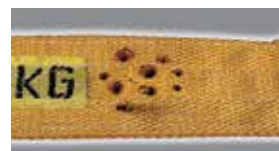
Повреждение в результате воздействия высокой температуры
